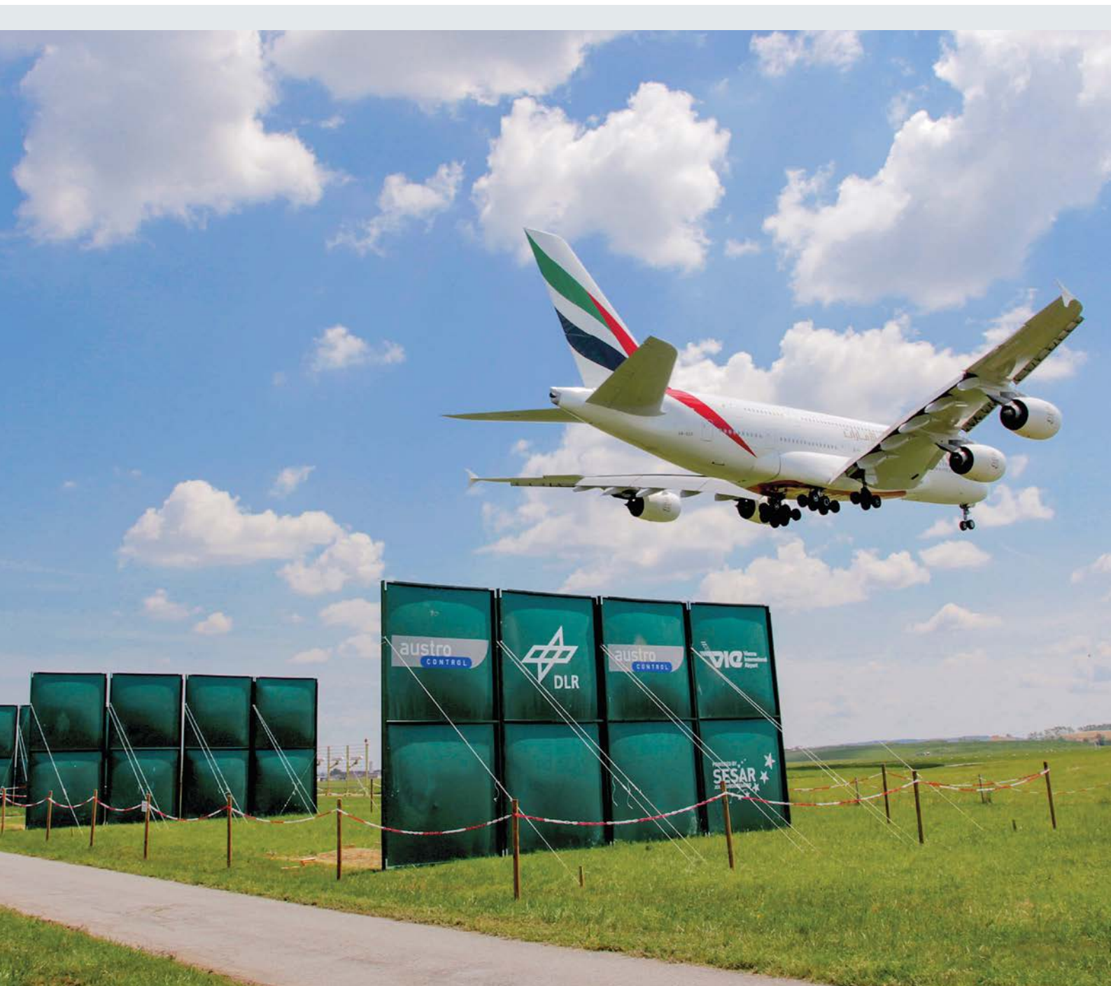
Mit der „Plate Line“ kann das Zerfallen von Wirbelschleppen beschleunigt werden. Foto: DLR
