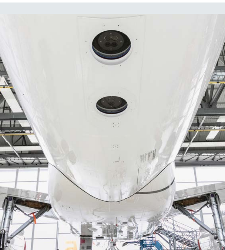
Die Kameraeinrichtungen des neuen A319 der Bundeswehr. Foto: Lufthansa Technik
